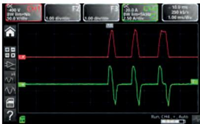
La valise de diagnostic permet la lecture des défauts, la mesure « paramètres correction de débit injecteur » (appelée aussi dérive des injecteurs) et la visualisation électrique de la commande de l'actionneur.
