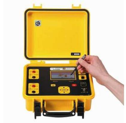
**Das FTV200 zeichnet sich durch eine außergewöhnliche Bedienungsfreundlichkeit aus: die integrierte Datenbank enthält die technischen Daten von mehreren Tausend verschiedenen Solarmodul-Typen!** Die Prüfung der Module erfolgt durch einfachen Vergleich der gemessenen I-U-Kennlinie (OPC) mit der entsprechenden Standard-Kennlinie des Herstellers (STC). Die farbige Darstellung der Prüfergebnisse erleichtert die Ablesung.
