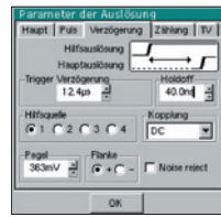
Die Effektivtriggerung für den Kanal erfolgt in diesem Beispiel mit einer Verzögerung von 12,4 µs gegenüber der Hilfsstromquelle.
