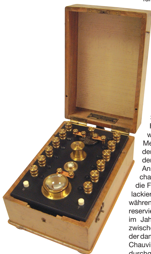
Dieses Kalibrier-Potentiometer von 1900 wurde in Verbindung mit einer Eichbatterie und einem Galvanometer wie dem oben abgebildeten verwendet. Es kostete damals 195 französische Francs oder etwa 158 Goldmark!
