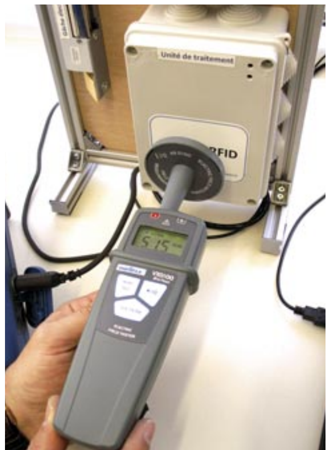
Figure 12 : Mesure du niveau de champ électrique
