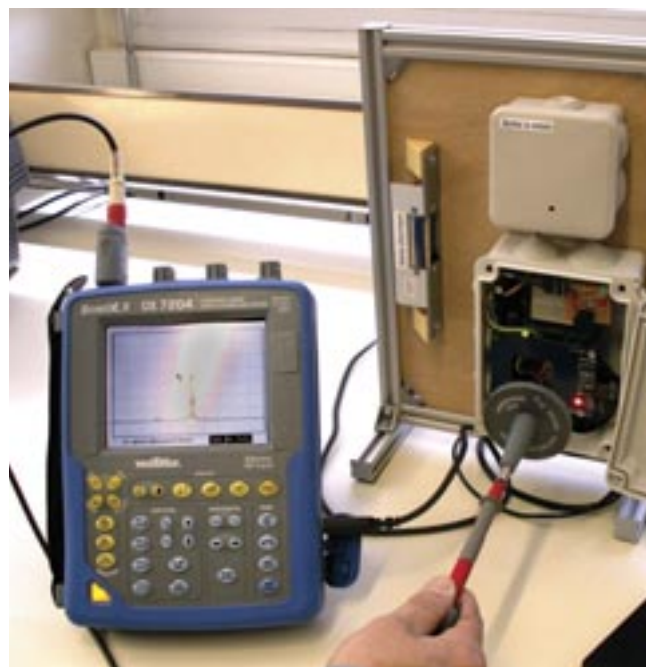
Figure 9 : Mise en évidence du rayonnement radiofréquence du lecteur RFID
